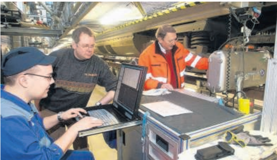
Erik Böttcher, Heiko Heidrich und Helmut Seifert (von links) bei der Ultraschall-Untersuchung einer Radsatzwelle des ICE-T „Passau“.
