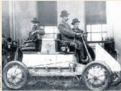
1900 zeigte Ferdinand Porsche in Paris ein E-Auto, das er für den Wiener Fabrikanten Ludwig Lohner konstruiert hatte. Der Lohner-Porsche war bis zu 58 km/h schnell.
